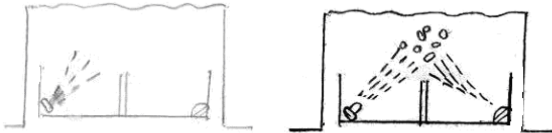
شكل ٣ - ٦ عمل الكاشف الكهروضوئي بطريقه تشتت الضوء
